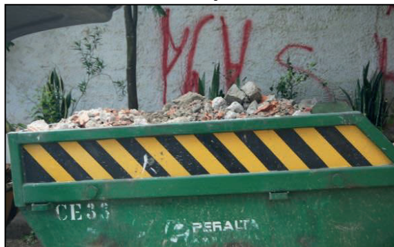
Figura 67– Caçamba de armazenamento dos RCCs nas Estações de Coleta
