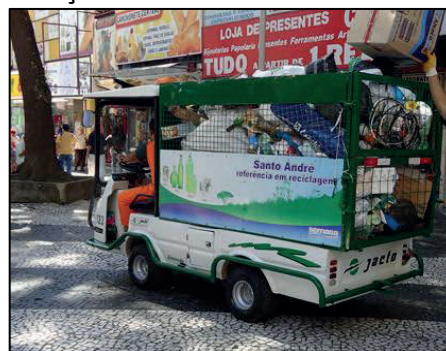
Figura 23 – Veículo elétrico para a realização da coleta dos resíduos secos
