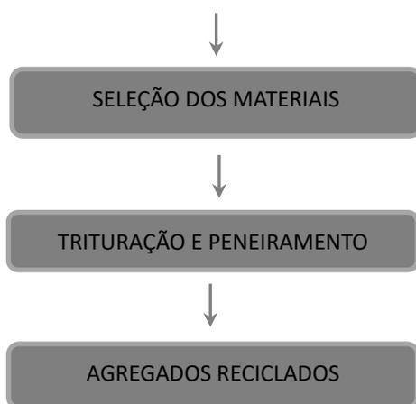
A britagem ou a trituração é a etapa principal do beneficiamento dos RCD, da qual resultam os agregados reciclados. Os RCD podem ser britados uma vez ou mais, dependendo das dimensões e granulometria desejadas para os agregados.
